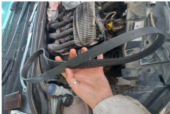
Figure 8: Courroie d'accessoire
