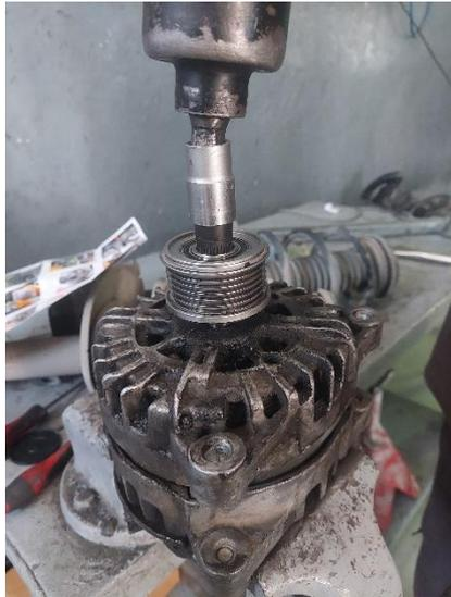
Figure 15: Démontage de la poulie
