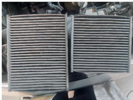
Figure 13: Filtre climatiseur
