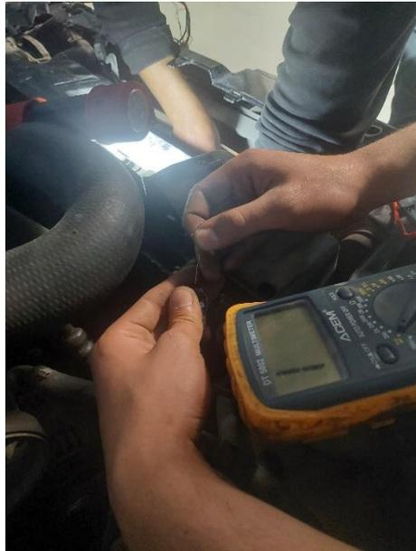
Figure 20: L'essai d'alimentation
