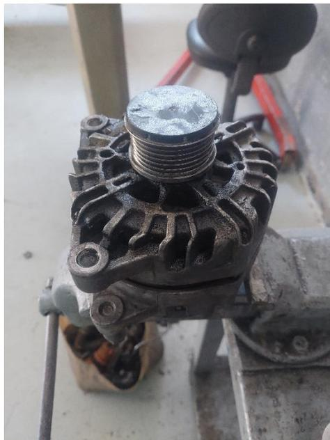
Figure 14: Alternateur déposé
