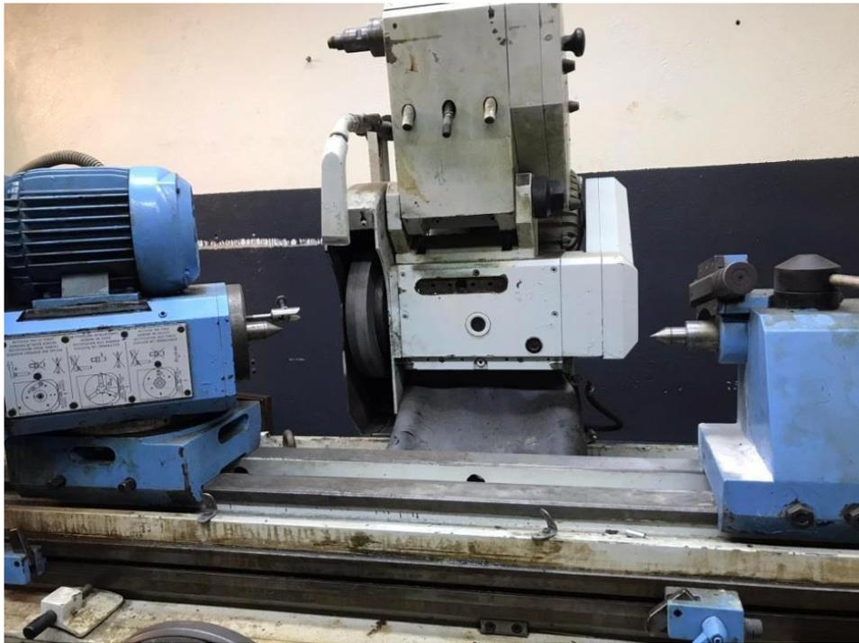
Figure 14: Rectifieuse cylindrique
