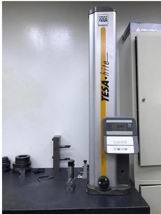
Figure 22: Colonne de mesure
