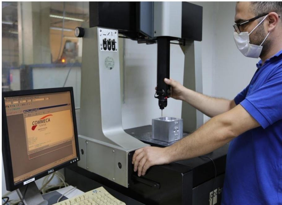
Figure 21: Machine de contrôle tridimensionnelle MMT
