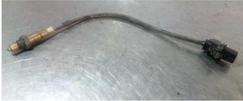
Figure 9 capteur sonde lambda
