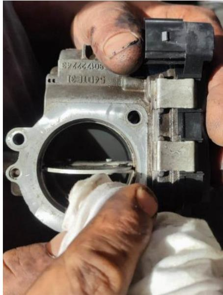
*Figure 18 nettoyage d'un corps papillon*
