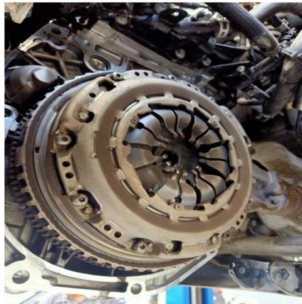
Figure3. 8: Mécanisme d'embrayage usée
