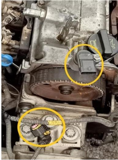
Figure 4. 2: Capteur d'arbre a came
