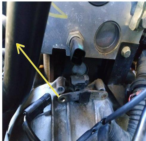
Figure3. 15: position vis de fixation
