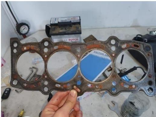
Figure 4. 7: Joint de culasse usé
