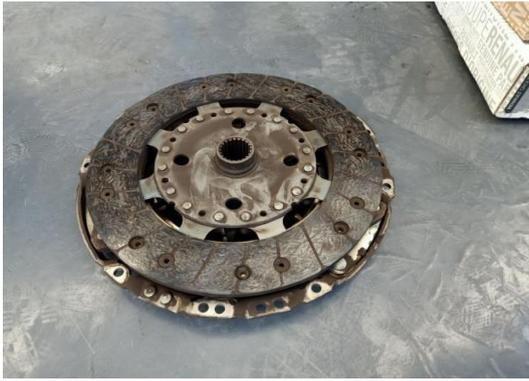
Figure3. 9: Disque embrayage usée
