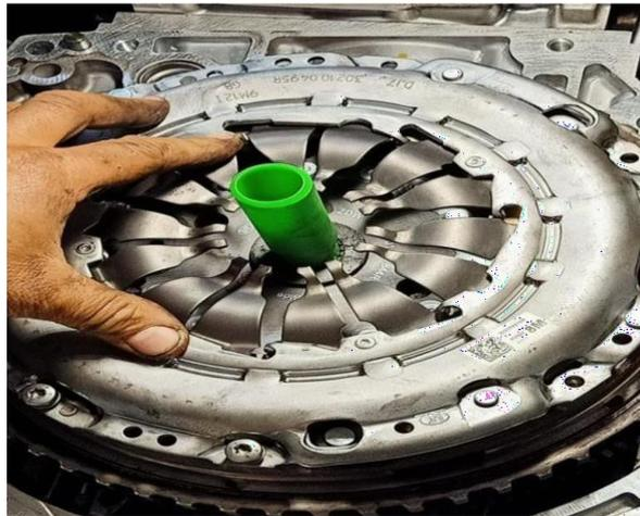
Figure3. 11: Mise en place de nouveau kit embrayage
