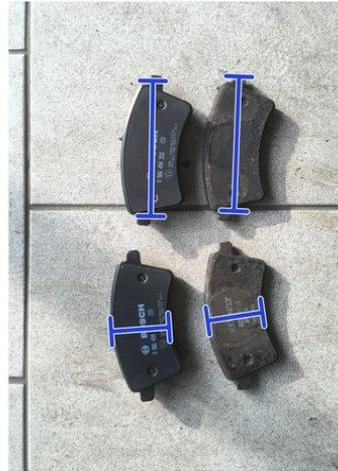
Figure3. 6: Plaquette usé et nouvelle plaquette
