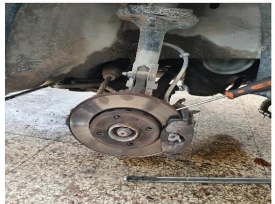
Figure3. 21: Fixation de disque frein
