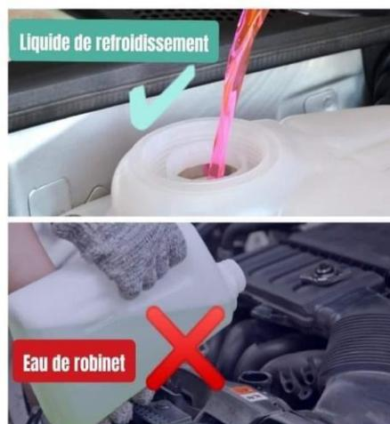
Figure 4. 12: Liquide de refroidissement
