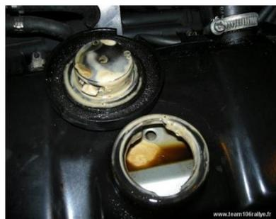
Figure2. 8: Mélange huile et liquide de refroidissement
