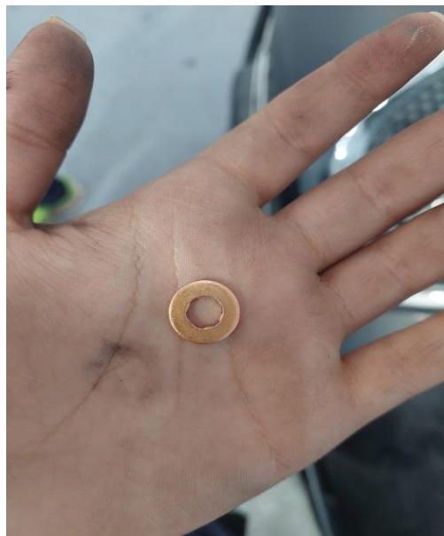
Figure 21: Un nouveau joint d'injecteur
