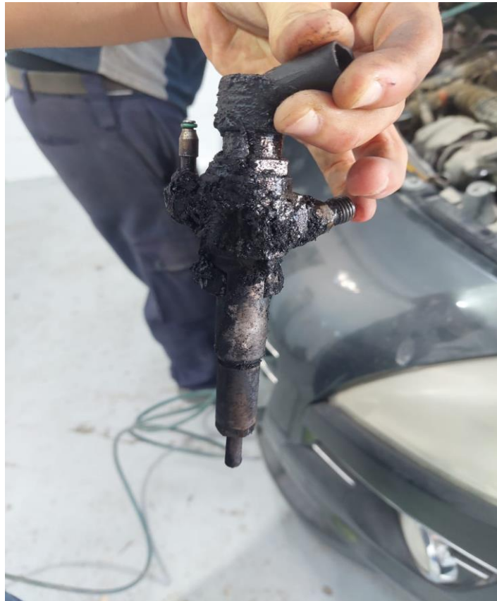
Figure 18: Un injecteur couvert par carburant
