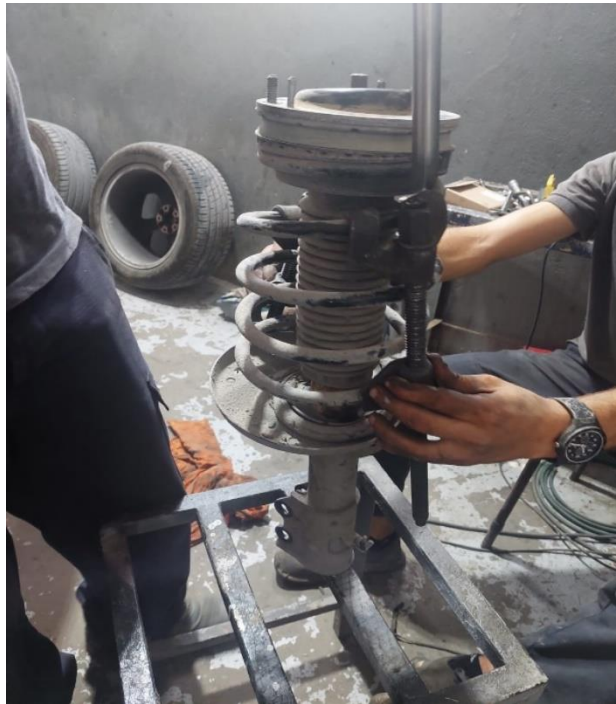
Figure 12: Ressort d'amortisseur comprimé à l'aide des crochets
