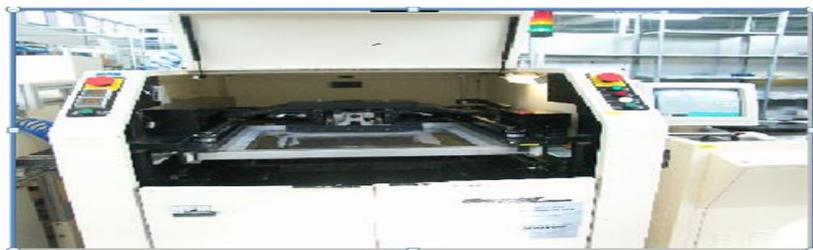
Figure 9 : Machine de sérigraphie DEK
