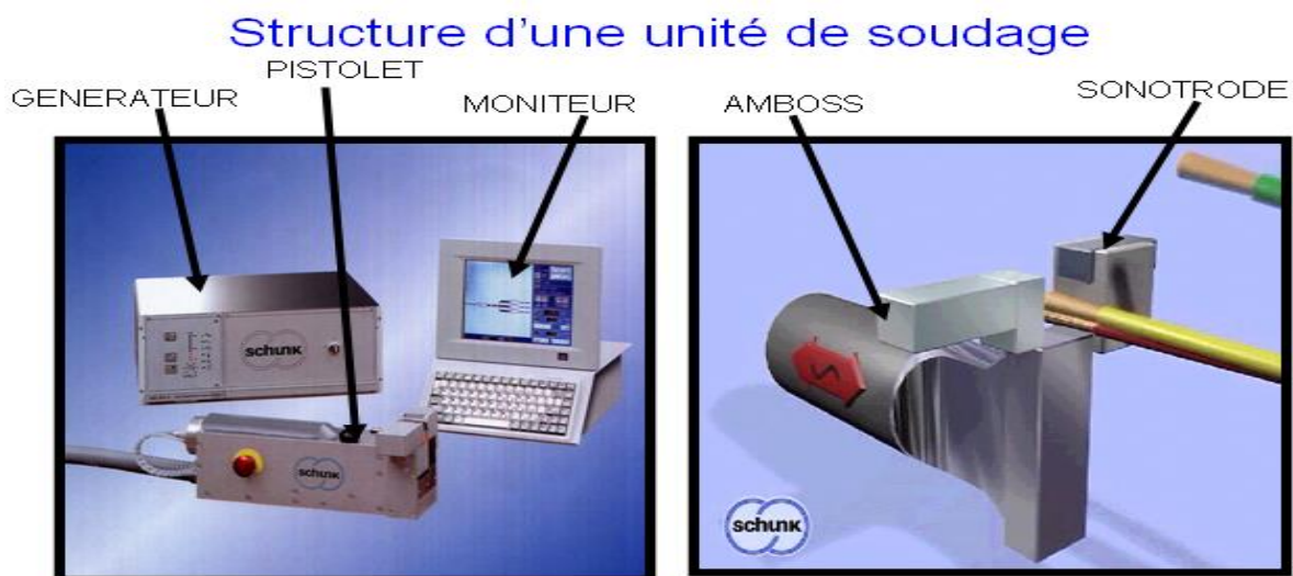
Figure 29: Les composantes de machine de soudage
