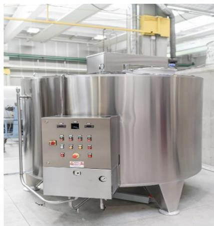
*Figure 21: tank de préparation prémix*
