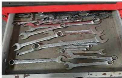
Figure 21: Clés à fourches
