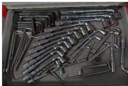
Figure 22: Clés à pipes
