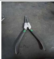
Figure 28: Pince à circlips
