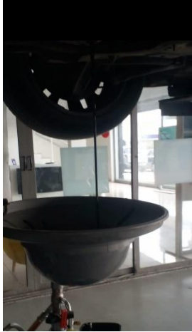
Figure 29: Processus de vidange d'huile
