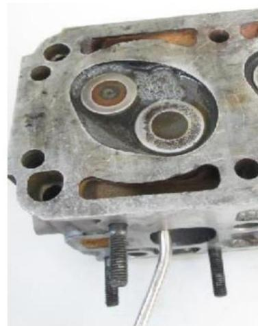
3. Les soupapes montées, renverser la culasse et verser une quantité d'essence dans la chambre de combustion pour vérifier l'étanchéité des soupapes
