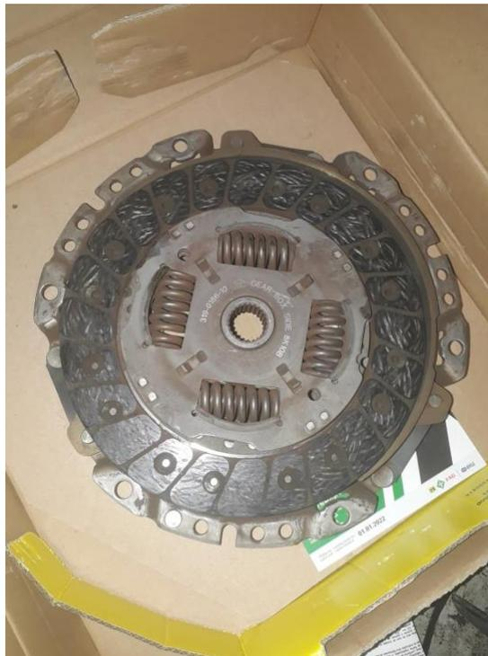
Figure 11 : Disque embrayage
