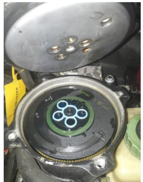
Figure 20 : pompe à gasoil
