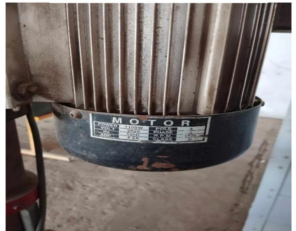
Figure 20: Moteur mono triphasé
