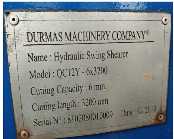
Figure 8: La plaque signalétique de la découpeuse
