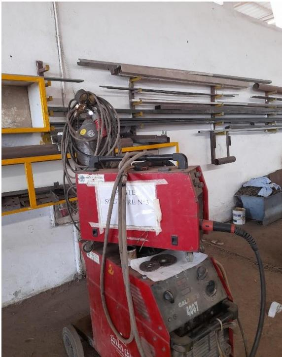
Figure 28: Poste soudure avec torche plasma
