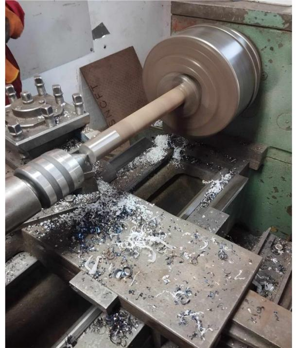
Figure 22: Montage entre pointe
