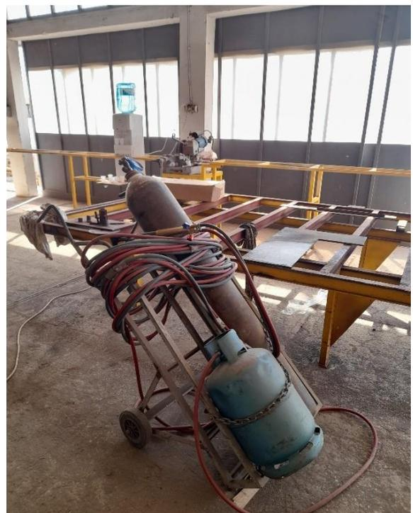
Figure 27: Poste soudure avec torche chalumeau
