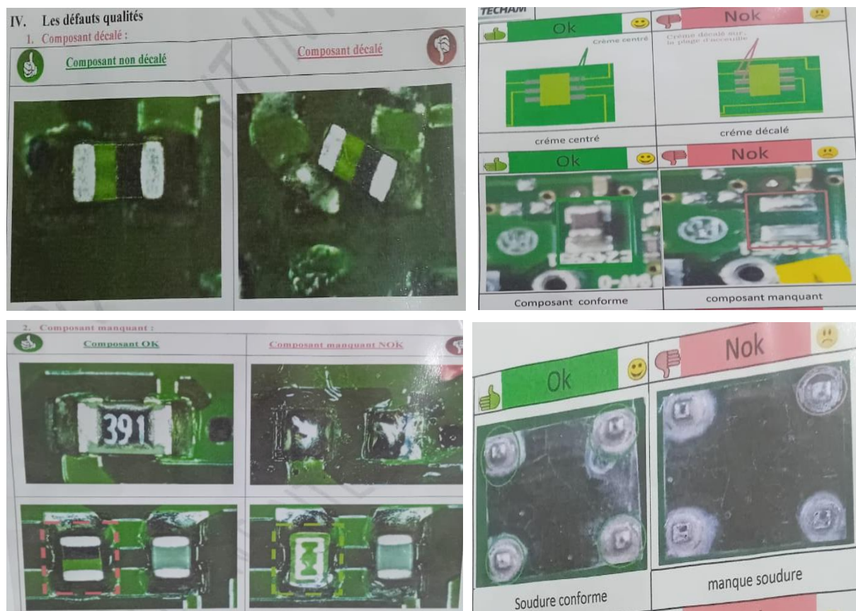
Figure 14 ;différents types de défaut analyser à partir du contrôle
